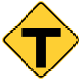
Intersección tipo 'T' adelante
